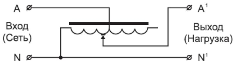
Регулирование напряжения осуществляется за счет изменения коэффициента трансформации. При перемещении графитовой щетки по обмотке автотрансформатора изменяется коэффициент трансформации и, как следствие, выходное напряжение. При коэффициенте трансформации, равном 1, вся электрическая энергия из сети передается в нагрузку.
